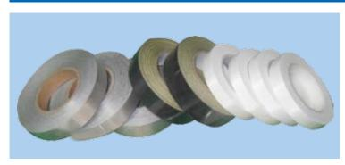
导电布胶带是在高强度的聚脂纤维布上镀以高导电的铜与镍 金属,再涂布以高导电性的压克力自粘胶而成。它具有极其 好的柔韧性、导电性,耐磨及抗高温性,另具极强的抗张力 性以及优良的服帖性。大量使用在笔记本CABLE线材、 LCD/PDP线材、手机线材上。EMI屏蔽效果最佳。
